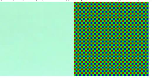
Показ белого поля в режиме RAW с включенным режимом 2x2 Pixels (слева) и с выключенным (справа).
